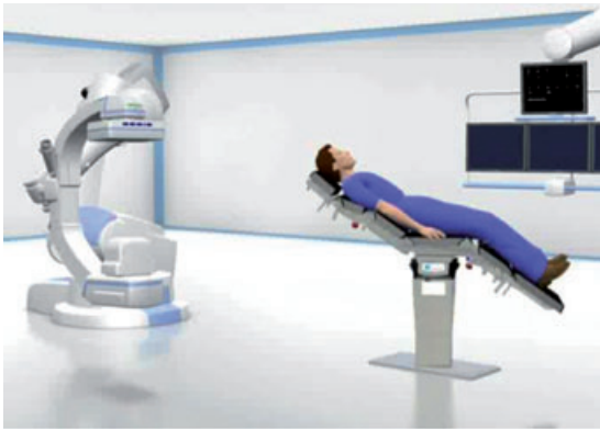
Abb. 11 Hybrid-Operationssaal mit intraoperativer 3D-Bildgebung zur Navigation: bodenmontierter mobiler Hochleistungs-C-Bogen mit acht Freiheitsgraden und Flatpanel-Detektor in Kombination mit konventionellem strahlentransparenten Operationstisch.
